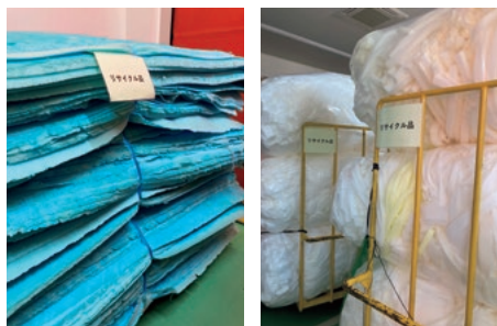
軟質ウレタンフォームのブロックをスライス加工した際に発生する上下品
